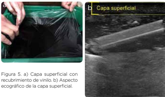
Figura 5. a) Capa superficial con recubrimiento de vinilo. b) Aspecto ecográfico de la capa superficial.
