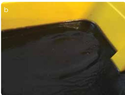
Figura 6. a) Proceso de reparación de ruptura gruesa utilizando secador de pelo a alta temperatura. b) Aspecto con la reparación terminada.
